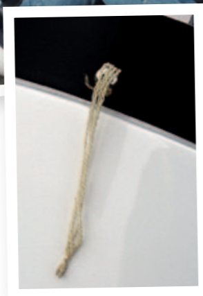
Simpel, aber effektiv: Der Wollfaden an der Frontscheibe zeigt an, ob man koordiniert fliegt oder schiebt
