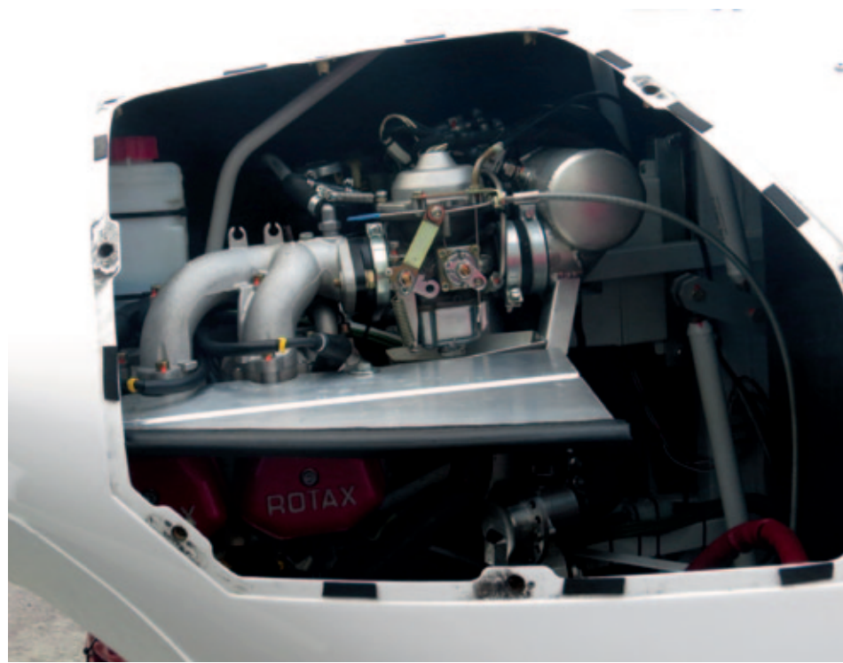
Angetrieben wird der Gyro von einem Rotax-Motor
